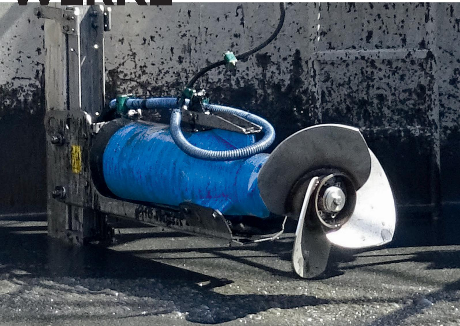
Für die RECK ORKA Tauchmotorrührwerke stehen vielfältige Anwendungsbereiche zur Verfügung. Ein großes Angebot an Zubehör ermöglicht den Einsatz in verschiedenen Behälterformaten, z. B. offene oder geschlossene Güllelager mit Betondecke oder Zeltdach. Dank eines umfangreichen Sortiments lassen sich die RECK ORKA Tauchmotorrührwerke problemlos an vorhandene Führungsrohre und Hebevorrichtungen montieren. Auch ein nachträglicher Einbau ist jederzeit möglich.
